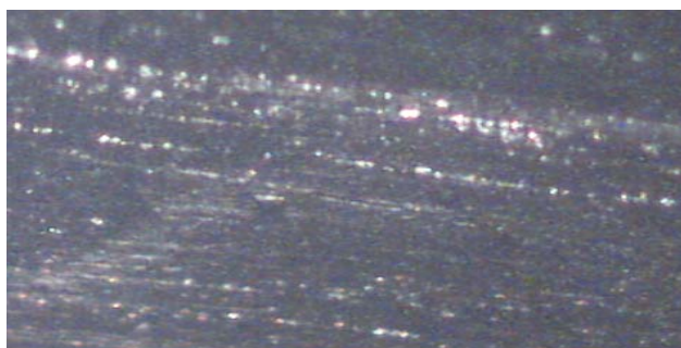
Fig.4 Imagen del poli (alcohol vinílico) oxidado (200 aumentos) después de 48 horas de radiación UV.
